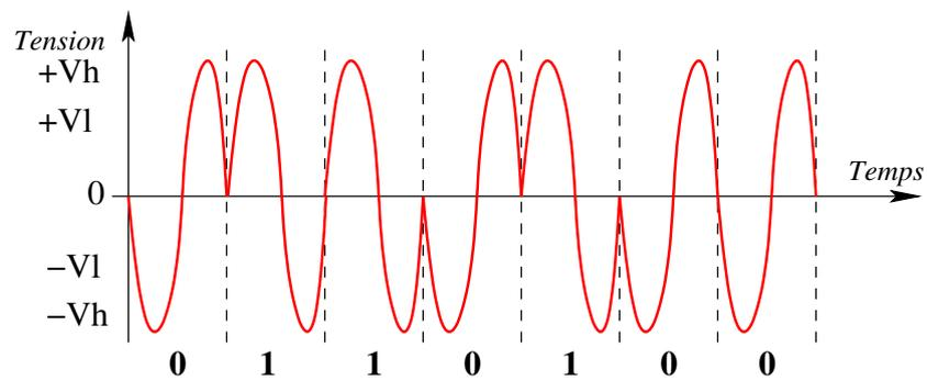
FIGURE 4 – Modulation par phase : phase négative  $\rightarrow$  0, phase positive  $\rightarrow$  1 par période.
