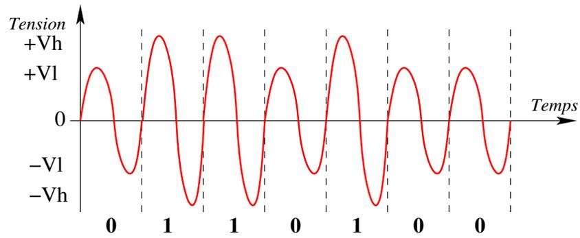
FIGURE 2 – Modulation par amplitude :  $Vl \rightarrow 0$ ,  $Vh \rightarrow 1$ .
